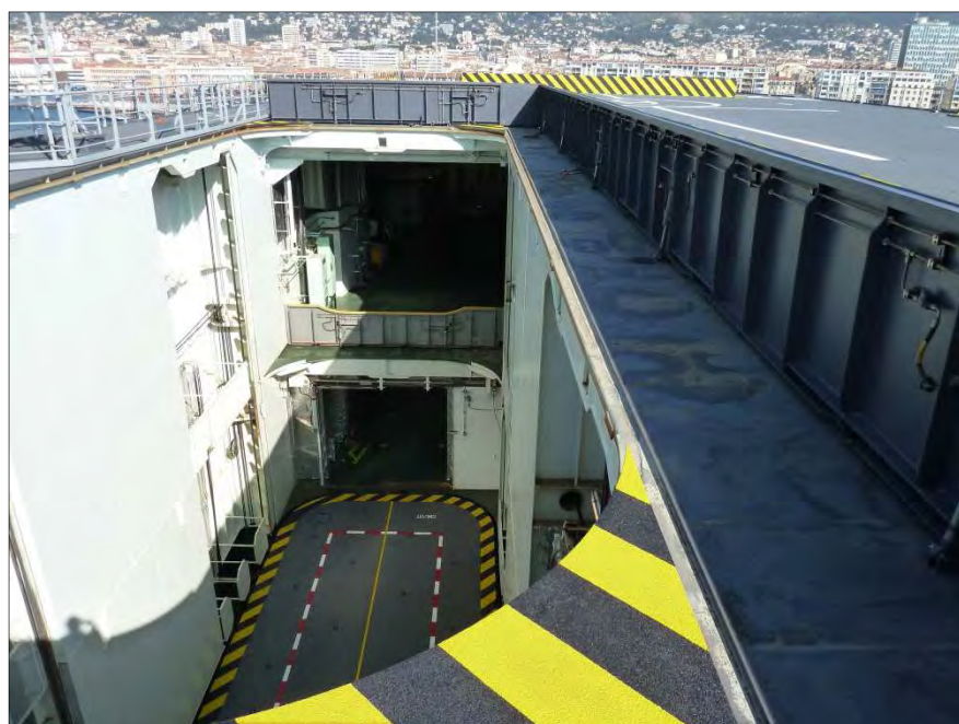
Ascenseur desservant les hangars (Photo AMK-BG)
